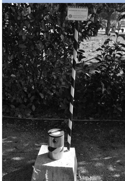
▼ Piezòmetre de control, per mesurar el nivell de les aigües subterrànies, a Canet de la Tallada. Foto: Puri Abarca
